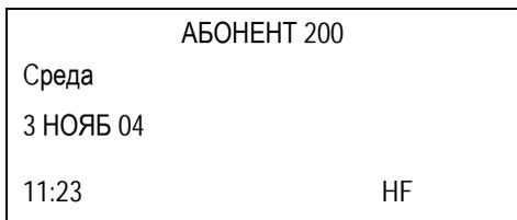
Переключение режима приема вызова HF-PV-TN осуществляется стрелками цифровой клавиатуры, при этом установленный режим отображается в нижнем правом углу дисплея
